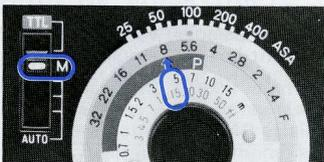
Le mode manuel assure une durée d'éclair fixe, ce qui requiert différentes ouvertures d'objectifs selon la distance séparant le flash du sujet (pour une puissance donnée). La vitesse de synchronisation au flash est expliquée à gauche. Les étapes sont les suivantes:
