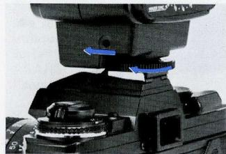
Lorsque la molette de fixation est desserrée (vers la droite) glissez le sabot du flash dans la griffe porte-accessoire de l'appareil. Puis tournez la molette vers la gauche pour fixer le flash sur l'appareil.
