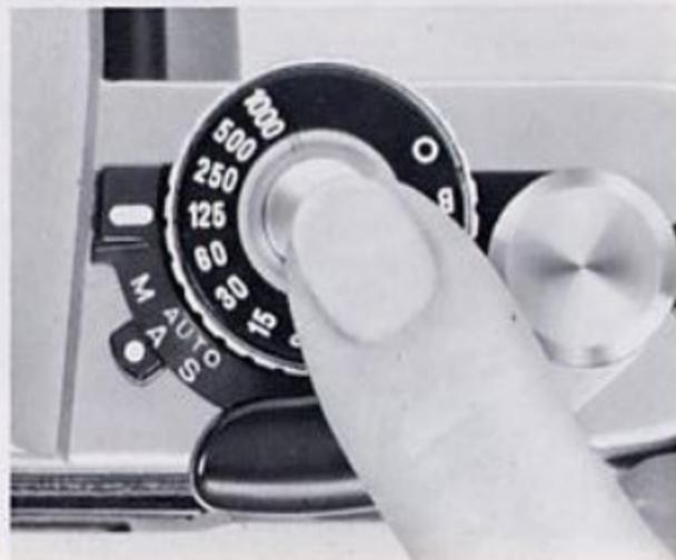
3. Réaliser votre 2ème exposition (la bobineuse avance automatiquement le film et arme à nouveau l'obturateur.)
