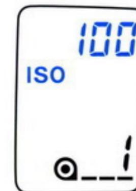
Avec un film DX, la sensibilité du film est lue automatiquement par l'appareil et affichée pendant 5 secondes sur l'écran.
