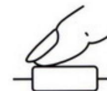
Pour déclencher, appuyer progressivement à fond sur le déclencheur, sans provoquer d'à-coups.
