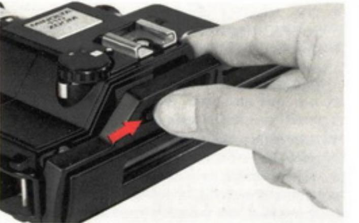
1. Schieben Sie die Rückwandentriegelung zum Sucher-Okular hin und klappen gleichzeitig die Rückwand auf.
