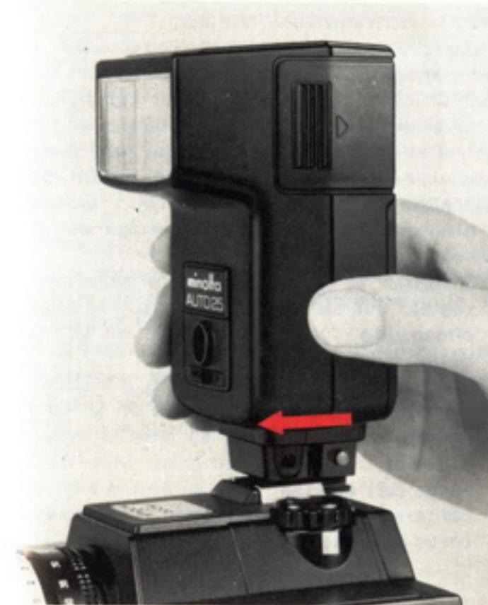
Die Minolta 110-Zoom erlaubt die Elektronenblitz-X-Synchronisation über den Mittenkontakt des Zubehörschuhs. Diese Blitzsynchronisation ist vorgesehen für Aufnahmen bei unzureichendem vorhandenem Licht. Zwar ist unter bestimmten Bedingungen auch das Aufhellblitzen möglich, doch wird diese Methode nicht empfohlen. Keine Blitzlampen, Vacublitz und Blitzwürfel verwenden! Blitzaufnahmen werden mit der 110-Zoom so gemacht:
