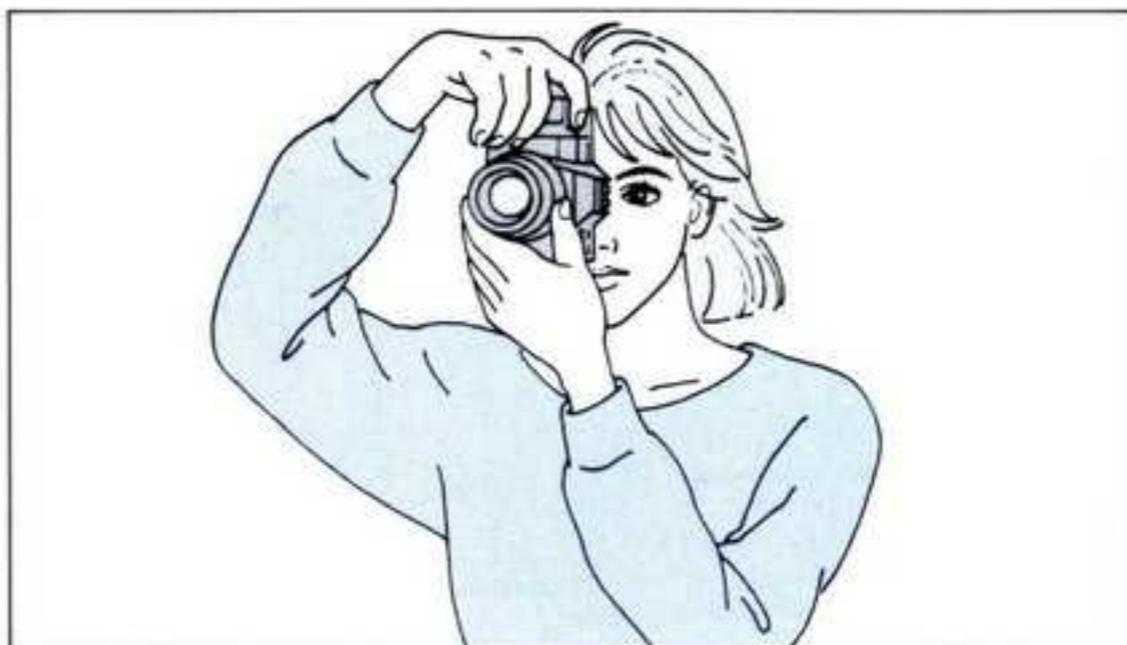
Nous vous recommandons de maintenir votre appareil selon les deux façons schématisées ci-après. En le maintenant fermement par sa poignée avec votre main droite, vous pourrez le déplacer horizontalement ou verticalement sans ôter vos mains des boutons de contrôle de l'appareil. En mise au point automatique, veillez à ne pas toucher la bague de mise au point de l'objectif.
