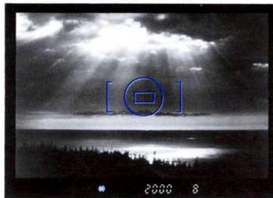
2. Maintenir le déclencheur partiellement enfoncé pour conserver sous tension le système de mesure.
