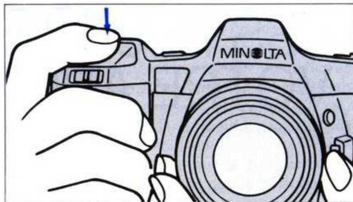
4. Pour obtenir une prise de vue, appuyer progressivement sur le déclencheur jusqu'à fond de course. Effectuer une pression douce et régulière, ne jamais appuyer brusquement sur le déclencheur ce qui pourrait provoquer un bougé de l'appareil et nuire à la qualité de l'image.
