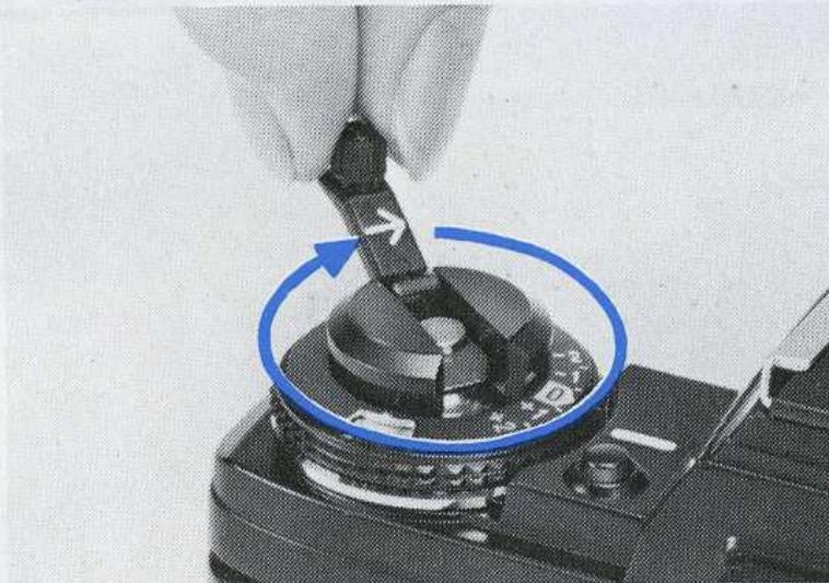
2. Soulever la manivelle de rembobinage et tourner en direction de la flèche jusqu'à ce que la barre rouge du signal de bon défilement de film disparaisse sur la gauche de la fenêtre. Une résistance se fait sentir, puis disparaît et le levier tourne alors librement.
