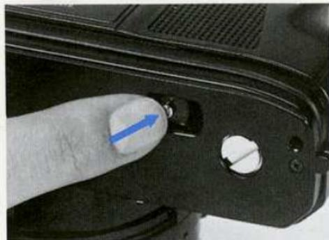
1. Pour rembobiner le film appuyer sur le bouton de débrayage de l'avance du film situé sous la semelle de l'appareil.
